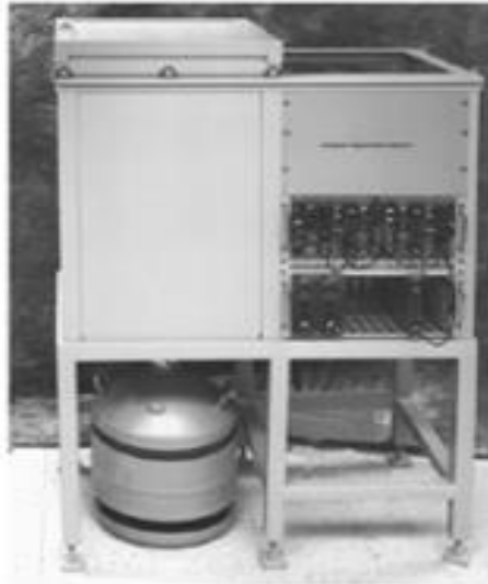
Şekil 16. ORTEC tarafından oluşturulan standart Compton bastırma sistemi
