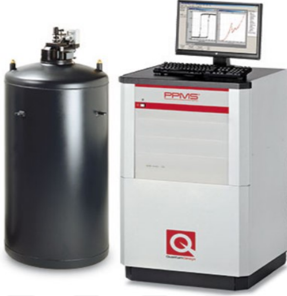
Şekil 14. M-H ölçümlerinde kullanılan Quantum Design Physical Property Measurement System (PPMS) cihazı
